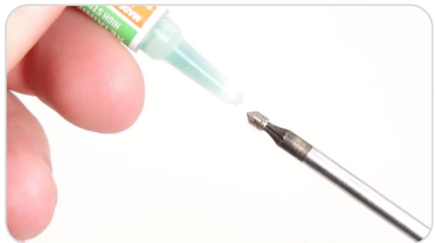
11. Påfør en lille mængde loctite på Unbrako-skruen.
