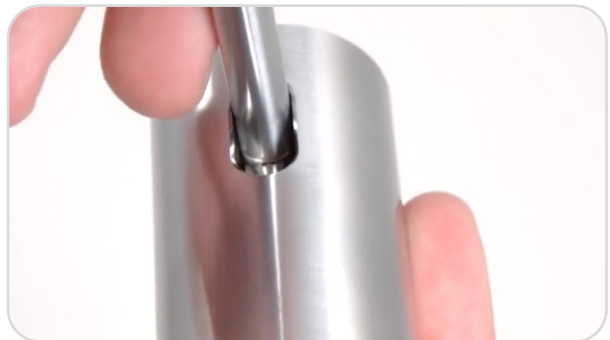
9. Montér udløbsrøret i stemplet - husk at smøre o-ringen. Brug gerne lidt hanefedt.
