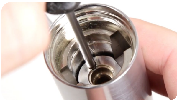
12. Isæt unbrako-skruen i sæbedispenserens stempel og spænd let.
